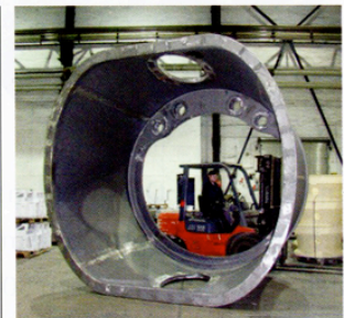
Guss für die weltgrößte Windenergieanlage. Foto: Meuselwitz Guss
